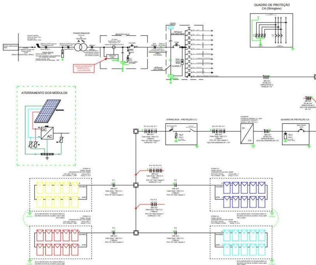
FIGURA 5: DIAGRAMA ELÉTRICO DE REFERÊNCIA DA SITUAÇÃO COM O SISTEMA FOTOVOLTAICO.
