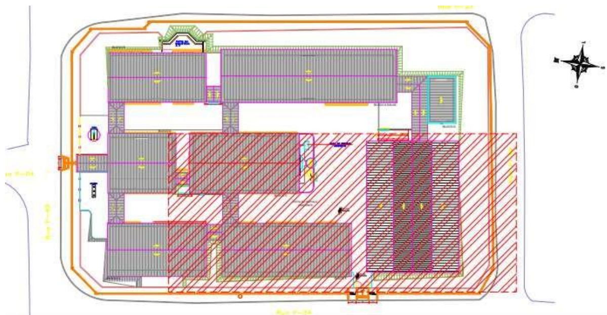
FIGURA 3 – ÁREA SUGERIDA PARA INSTALAÇÃO DO SISTEMA FV.
