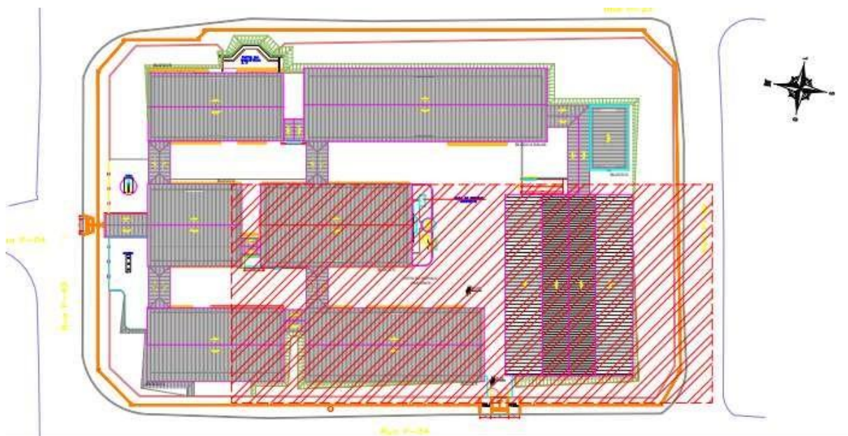
FIGURA 3 – ÁREA SUGERIDA PARA INSTALAÇÃO DO SISTEMA FV.
